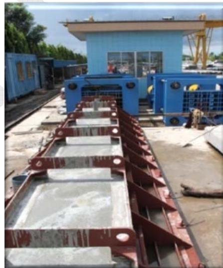
Hình 24. Cọc ván bê tông dự ứng lực
