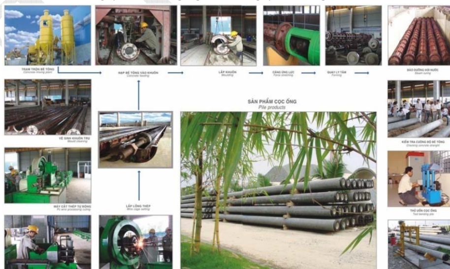
Hình 23. Quy trình công nghệ bê tông ly tâm ứng lực trước
